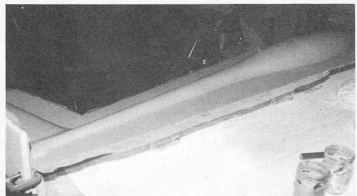
Troisième opération du deuxième demi-moule. Une couche de mat de verre en surface. On devine les mèches dans les angles vifs.
